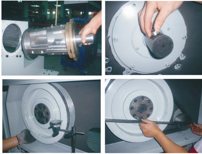
图 3-8: 轴承、电机、带轮及皮带安装
