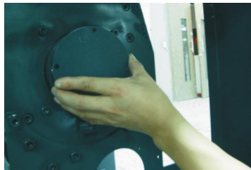
图 3-7: 轴承盖板安装示意图
