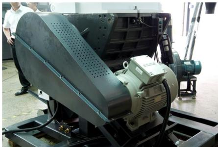
图 6-8: 皮带轮及电机的安装四
