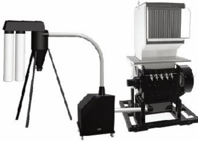
分离式粉碎料输送装置是指通过风机把粉碎后颗粒料送至旋风器分离粉碎料与风，便于粉碎料的收集，机型后加注“SC”。(SG-50 标配，SG-50B 选配)
