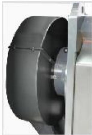
可增加惯性，从而加大切削能力。同时，可令轴承受力更为平衡，使用寿命更长。机型后加注“FW”。(SG-50 标配，SG-50B 选配)
