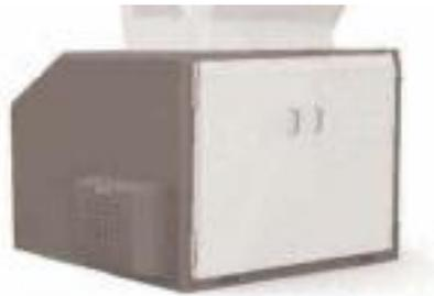
采用全隔音的进料箱在机器运行中，工作噪音会大大下降，并在进料口处安装了安全挡料帘，使材料在被破碎时不会飞溅出来。(SG-50 标配，SG-50B 选配)
