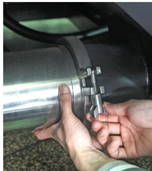
图 4-3: 松开快速管夹图
