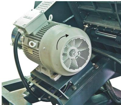
图 3-6: 电机转向图
