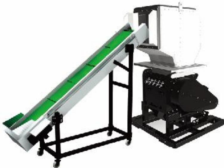
传统的大型粉碎机对于喂料存在一定困难，通常需要将粉碎机埋于地坑中或是搭建平台喂料，利用输送机轻易的把料送进粉碎室中进行粉碎，机型后加注“BCF”
