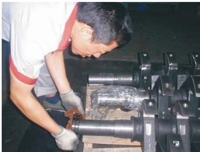
图 6-4: 刀架及轴承的安装
