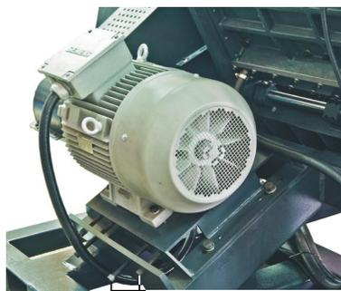
图 6-7: 皮带轮及电机的安装三
