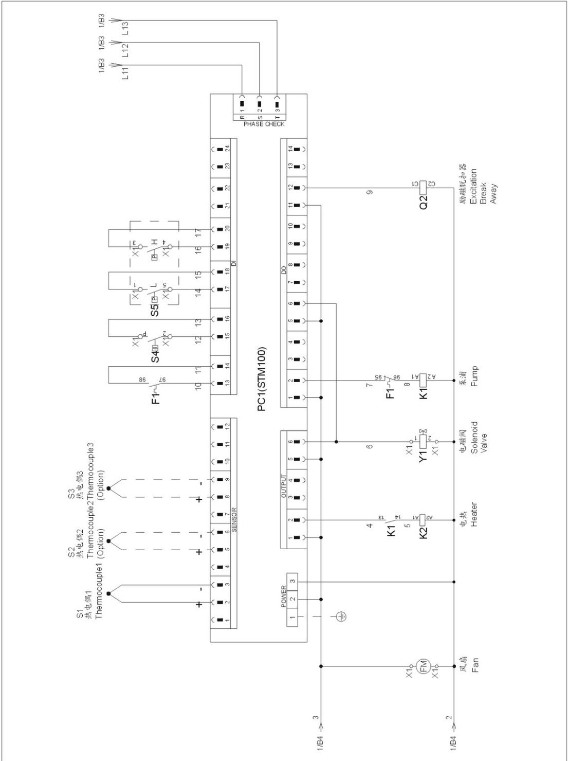
图 2-26: 控制电路图(STM-607W~1220W 230V)
