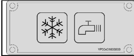
进水口：机器补水/冷却水进口
