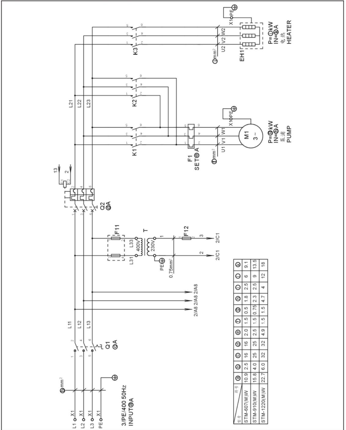
图 2-10: 电路图(STM-607WR~1220WR 400V)
