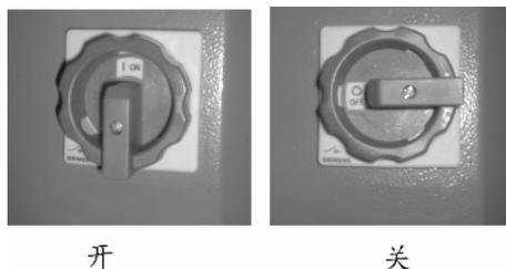
图 4-3: 主电源开关
