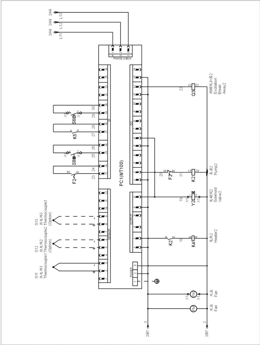
图 2-15: 控制电路图二(STM-607W-D/910W-D 400V)
