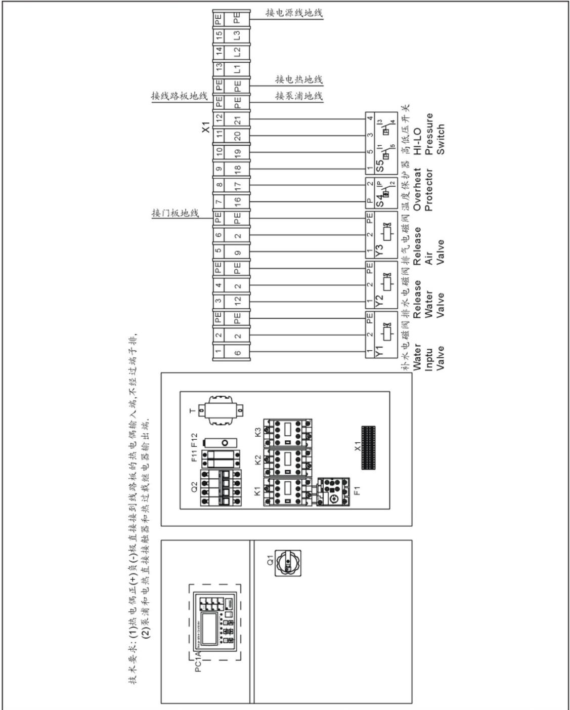
图 2-12: 电气元件布置图(STM-607WR~1220WR 400V)
