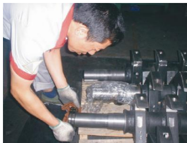
图 3-2: 刀架及轴承的安装
