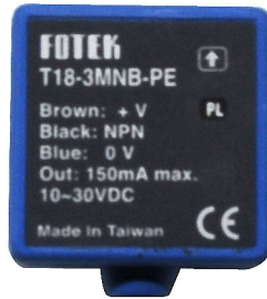
图 2-3: 对射式光电开关
