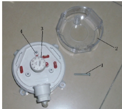
图 3-5: 负压开关调节步骤图
