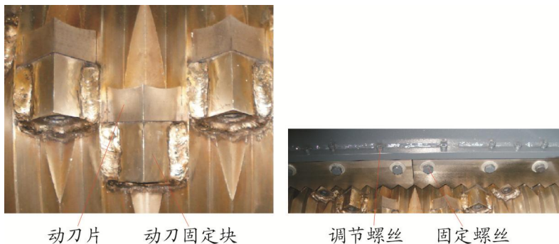
图 3-8: 定刀与动刀的安装
