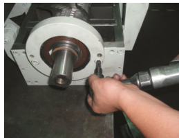
图 6-13: 定刀与动刀的安装示意图二
