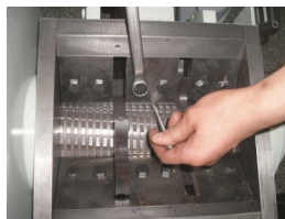
图 6-14: 定刀与动刀的安装示意图三
