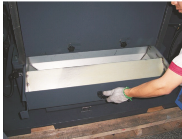
图 6-13：筛网、网架及集料盒安装五
