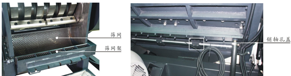
图 6-10：筛网、网架及集料盒安装二
