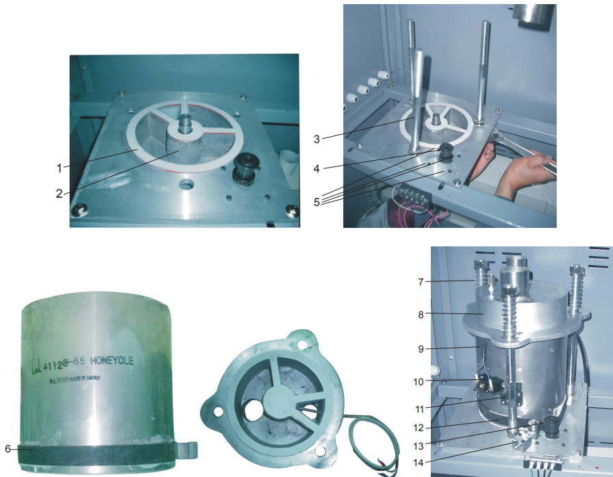
图 6-3: 蜂巢转轮安装示意图(SD-40H~700H)
