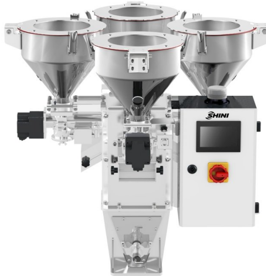
图 1-1: 容积式比例混合机 SPM-40-4
