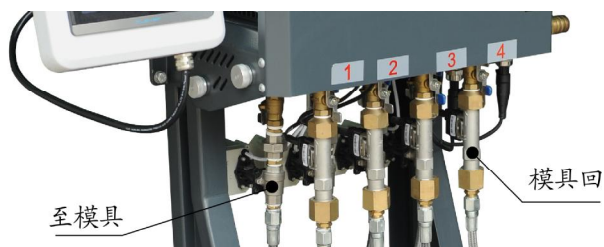
图 3-1：至模具/模具回管路连接示意图
