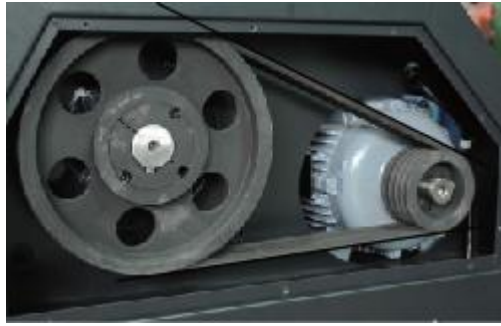
图 6-6: 轴承、电机、带轮及皮带安装
