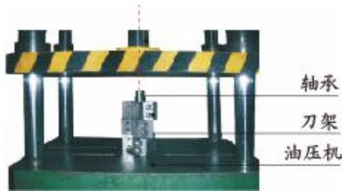
图 6-1: 刀架轴安装示意图
