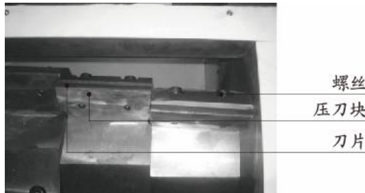
图 6-15: 动刀与定刀的安装
