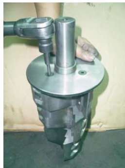
图 6-2: 档料板安装示意图
