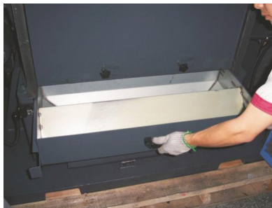
图 6-13: 筛网、网架及集料盒安装五
