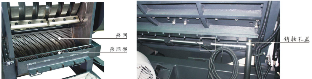
图 6-10: 筛网、网架及集料盒安装二
