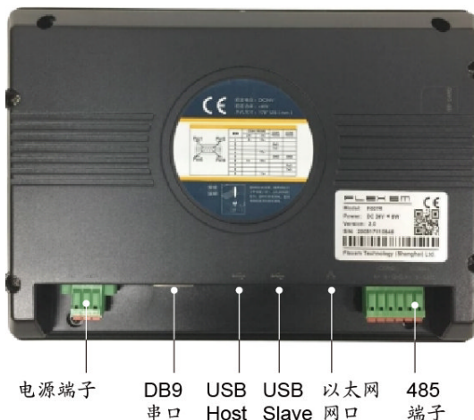
图 4-2: 触控式电阻屏背后端子的接线定义
