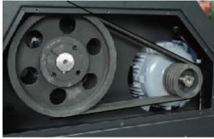
图 6-6: 轴承、电机、带轮及皮带安装
