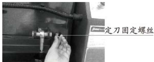
图 6-13: 压刀板固定螺丝
