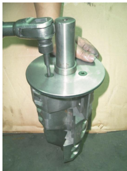
图 6-2: 档料板安装示意图
