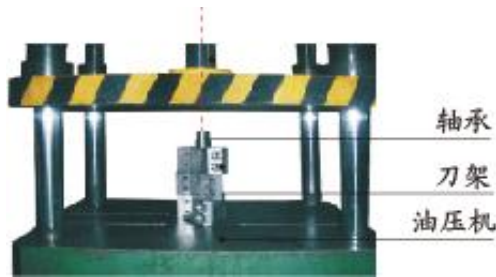
图 6-1: 刀架轴安装示意图
