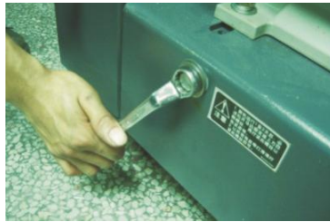
图 6-18: V形带的调整图二
