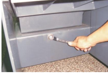
图 6-17: V形带的调整图一
