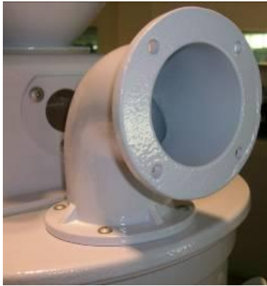
图 3-4: 左: 干燥机排风口弯头
