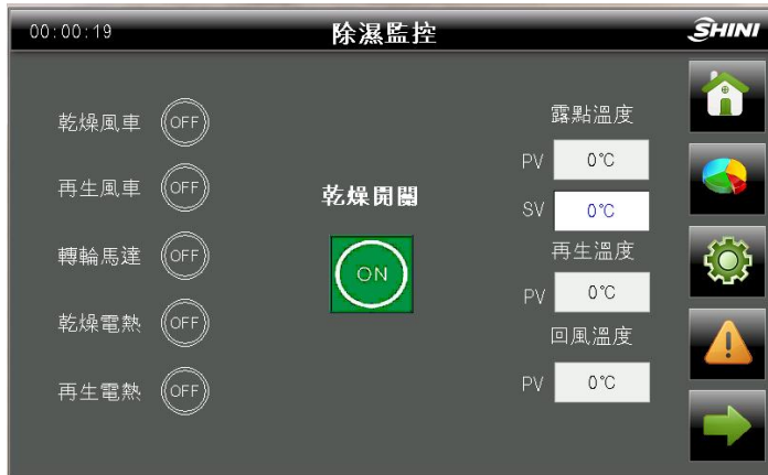
图 4-4：除湿监控画面
