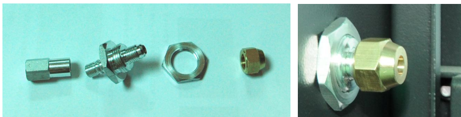
图 6-7: 原有机台的铜接头组件
