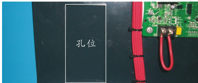
图 6-5: 露点计安装孔位
