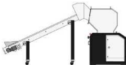
图 6-2: 静音集中粉碎机 SG-36/43 搭配输送带投料的应用
