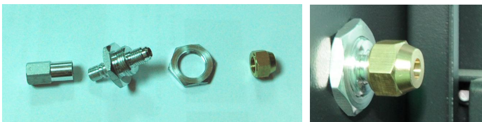
图 6-9: 原有机台的铜接头组件
