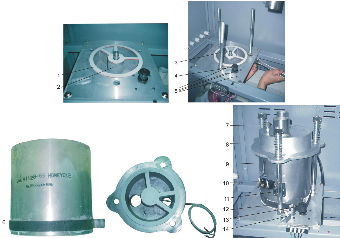
图 6-3: 蜂巢转轮安装示意图
