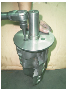
图 6-2: 档料板安装示意图
