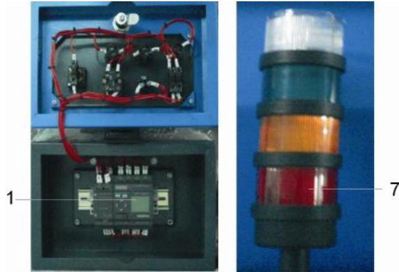
图 2-16: 控制面板电控箱/四段指示灯
