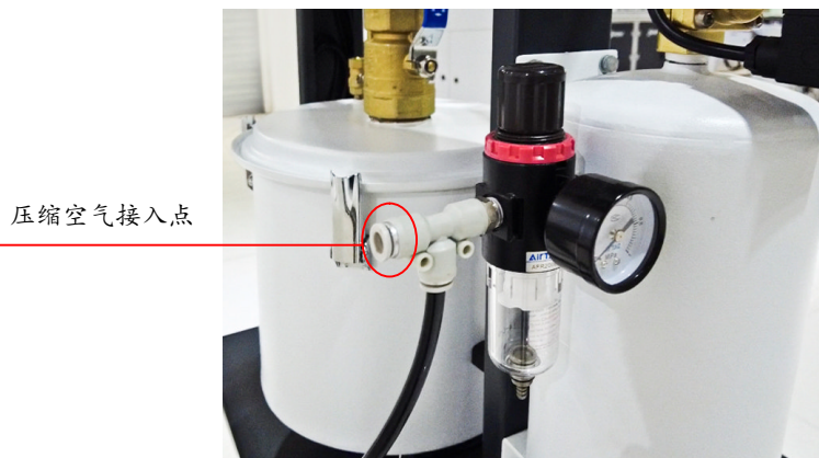
图 3-2：压缩空气接入点
