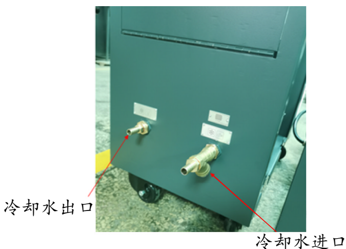
图 3-2: 冷却水管路的连接
