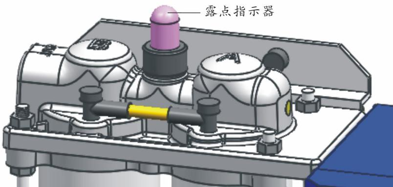
图 6-3: 露点指示器
