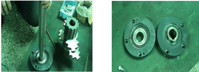
图 6-15: 拆卸左右轴承座步骤三
