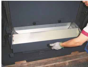
图 6-13: 筛网、网架及集料盒安装五
