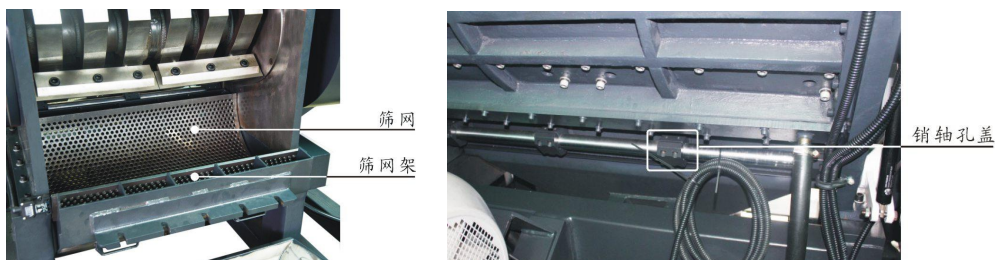
图 6-10: 筛网、网架及集料盒安装二
