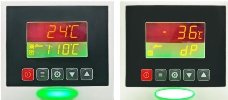
图 4-2: 露点计设置示例图
