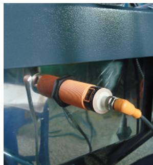
图 4-29：储料桶上的料位开关图
