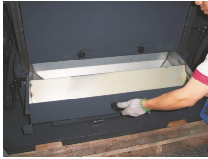
图 6-15: 筛网、网架及集料盒安装五
