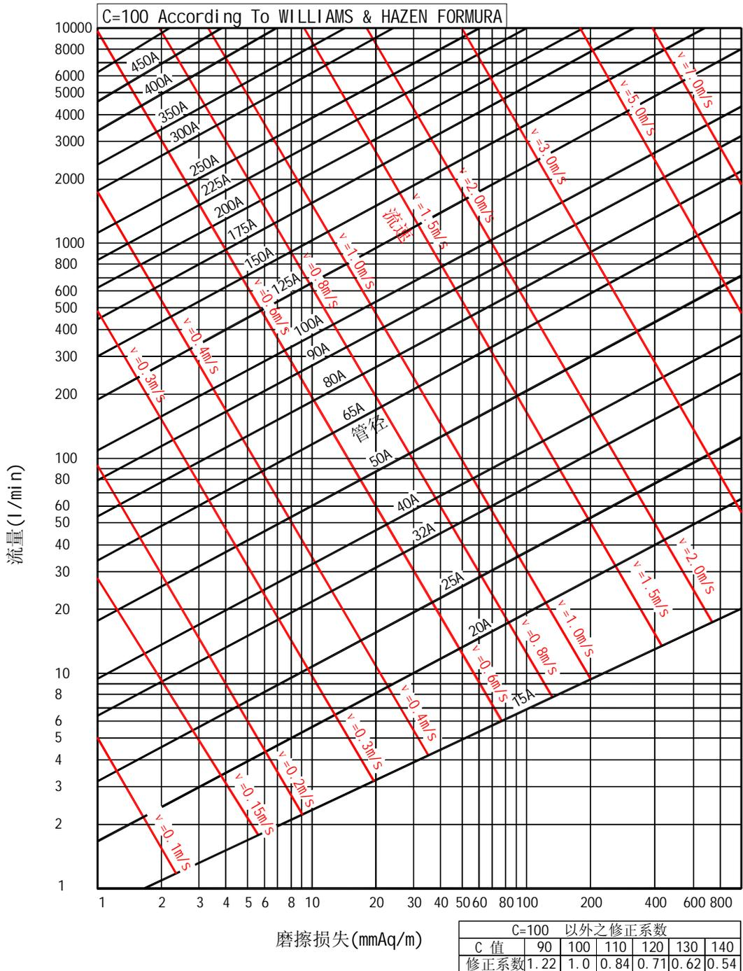
例如，在摩擦损失为 30~80 (mmAq/m)，流量为 80 (L/min)，可选用 40A (直径为 40mm) 的管径。
