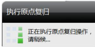
在伺服原点复归过程中，如果松开安全开关或者使劲完全按下安全开关，伺服原点复归操作将会马上中止。
