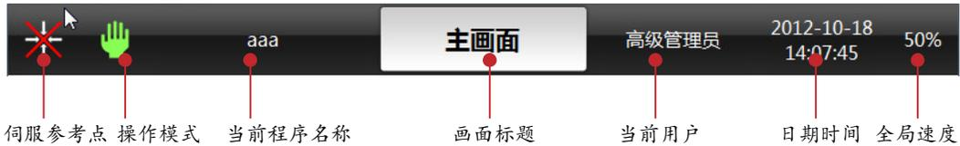
**伺服参考点标志：**显示系统上电后伺服有无经过原点复归寻找参考点。点击该区块将会执行伺服原点复归操作。
