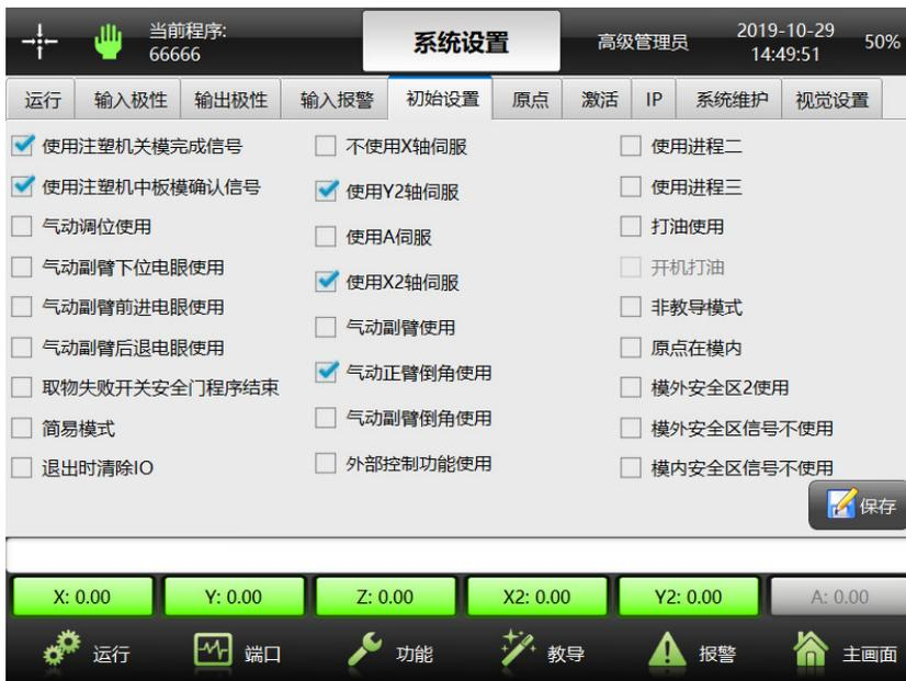
使用注塑机关模完成信号：设置关模完信号使用，则在开模完之前必须有关模完信号，开模完才有效。
