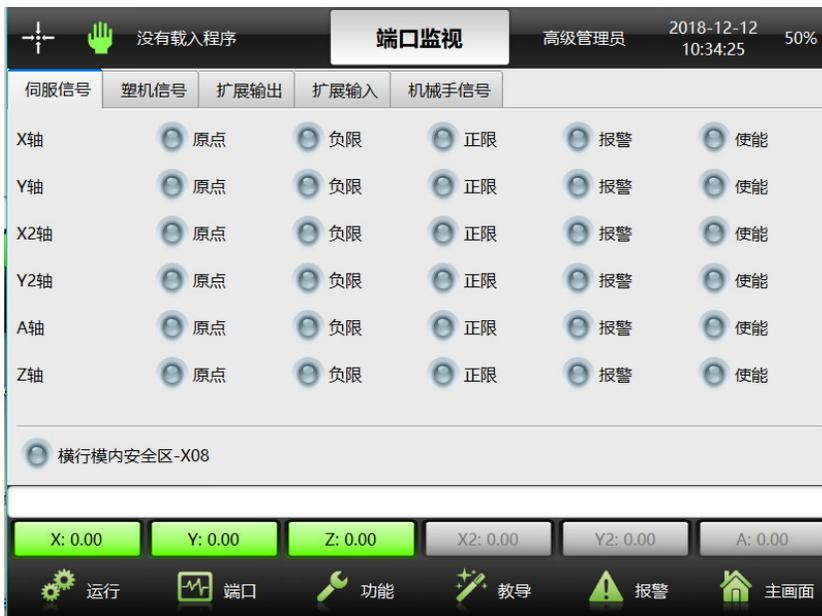
塑机信号：能监视注塑机输入输出信号。也可以控制注塑机信号的打开。
