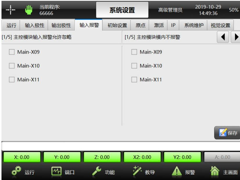
初始设置：设置关模完、中板模等信号是否使用。调位使用：设置气动调位是否使用等。非教导模式是指使用程序模板，只能修改程序参数不能教导程序。勾选使用进程，可以实现多进程。勾选原点在模内，系统默认原点在模外，可以切换到模内。
