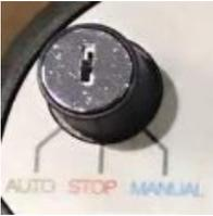
功能选择旋钮。把旋钮拨到 **AUTO** 时，则进入机械手自动运行等待画面，把旋钮拨到 **STOP** 时，如果机械手在自动运行时，则机械手停止运行并进入机械手自动运行等待画面，且机械手不能手动运行，把旋钮拨到 **MANUAL** 时，机械手进入手动页面可以手动运行各个轴。
