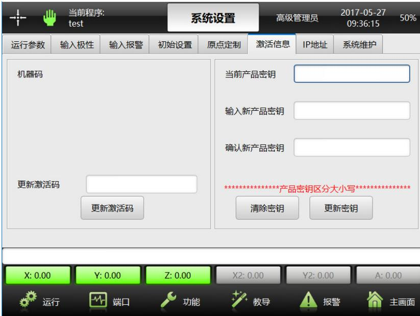
先设置一个产品密钥，然后再将密钥和机器码设置到电脑上的软件，生成新的激活码。激活码有效时间可以设置。
