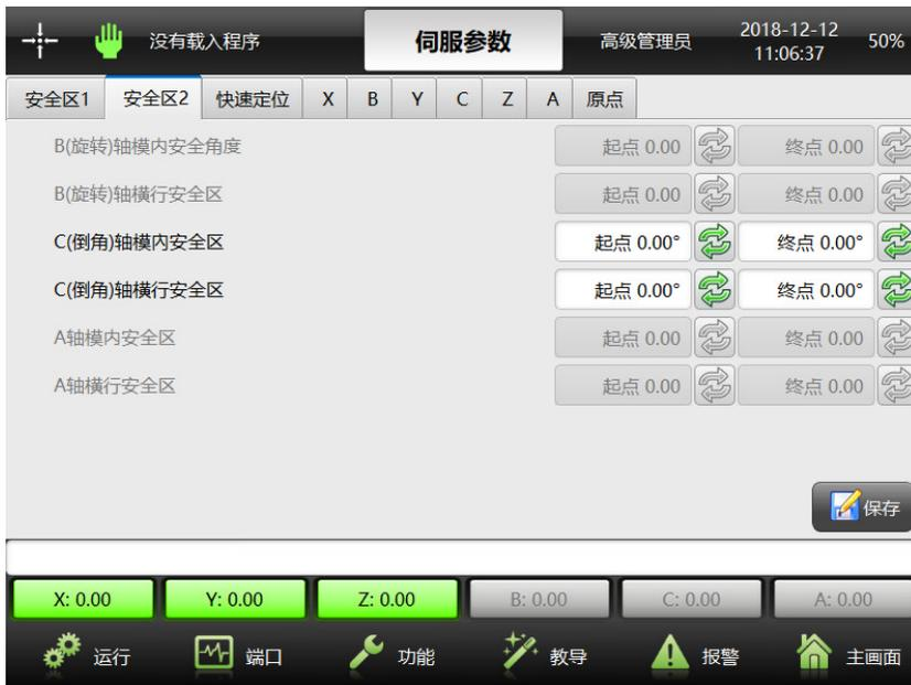
设置伺服的安全区域参数时，为了保证设置参数的正确性，不能通过直接输入伺服位置坐标来设置，只能手动控制伺服移动到确定的位置，然后点击要设置值旁边的伺服位置同步按钮把对应的伺服位置刷新到输入框。
