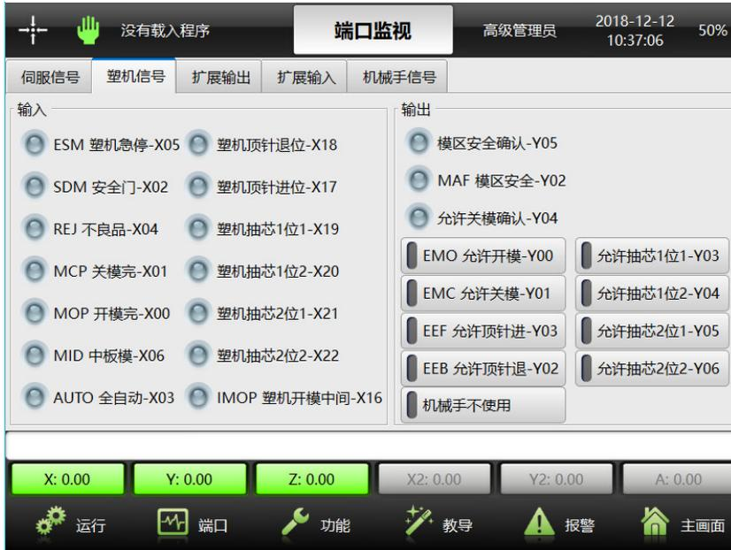
机械手信号：监视和操作机械手上的气动信号。点击
