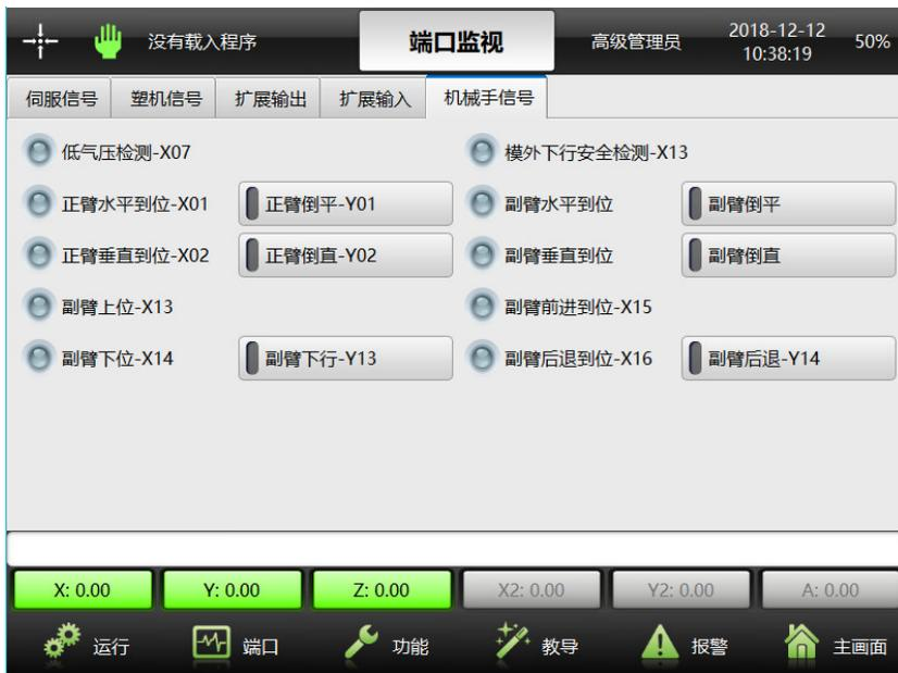
在扩展输出界面点击输出端口控制对应输出端口开启/关闭时，必须要按下手动安全开关，防止误操作。
