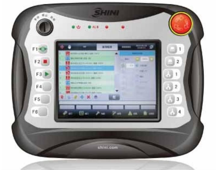
F1 机械手复归（按下此按钮并同时按下手控器侧面安全开关，机械手进入复归模式。）
