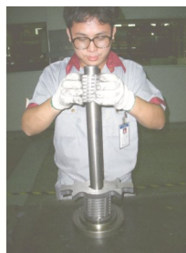
图 6-12: 定刀与动刀的安装示意图一
