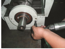
图 6-13: 定刀与动刀的安装示意图二
