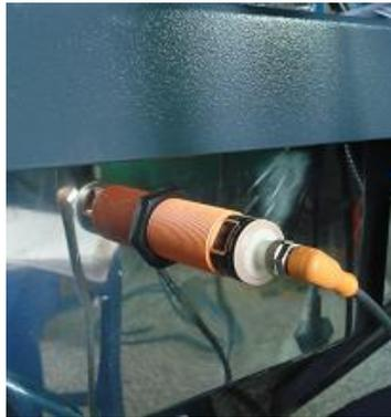
图 4-32: 储料桶上的料位开关图
