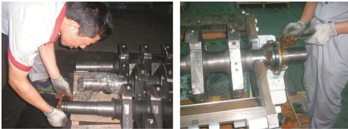
图 6-4: 刀架轴安装示意图
