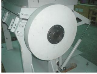
图 6-13: 皮带轮及电机的安装(SG-3675)四
