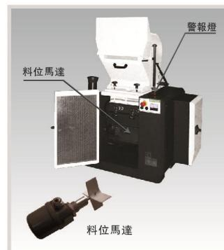
图 2-9: 满料报警装置
