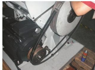
图 6-7: 皮带轮及电机的安装(SG-3650)三
