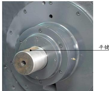
图 6-5: 皮带轮及电机的安装(SG-3650)一
