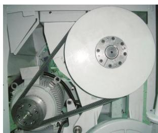
图 6-9: 皮带轮及电机的安装(SG-3650)五
