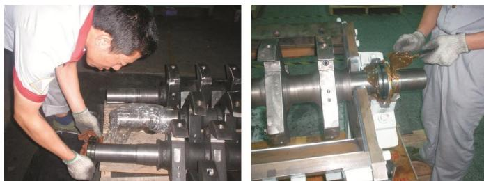
图 6-4: 刀架轴安装示意图
