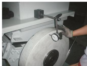
图 6-11: 皮带轮及电机的安装(SG-3675)二
