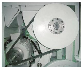
图 6-9: 皮带轮及电机的安装(SG-3650)五
