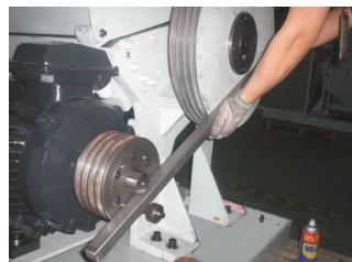
图 6-8: 皮带轮及电机的安装(SG-3650)四
