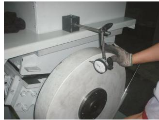
图 6-6: 皮带轮及电机的安装(SG-3650)二
