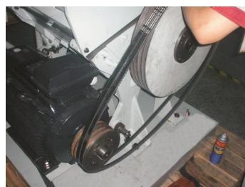
图 6-12: 皮带轮及电机的安装(SG-3675)三
