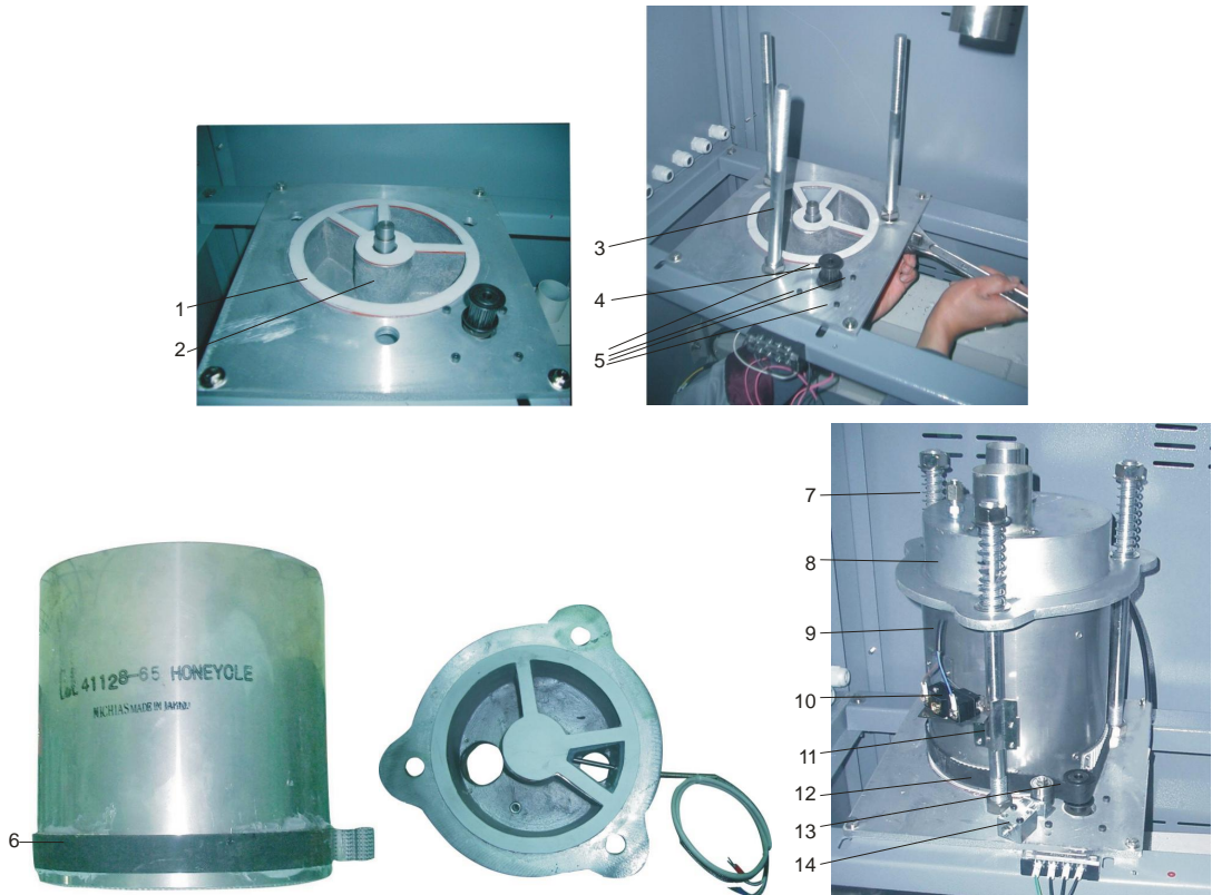
图 6-7: 蜂巢转轮安装示意图
