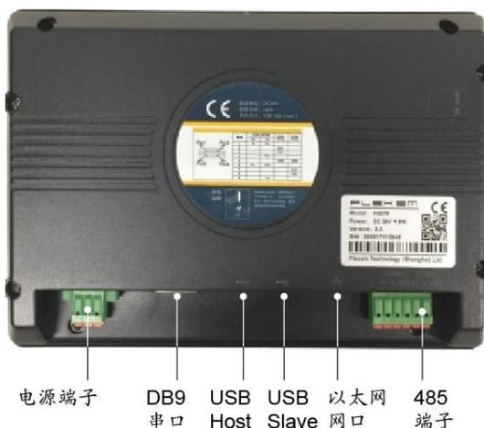
图 4-2: 触控式电阻屏背后端子的接线定义
