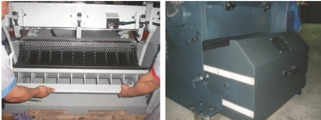
图 3-9: 筛网、网架及集料盒安装
