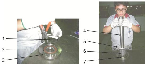
图 3-3: 轴承及刀架安装示意图一
