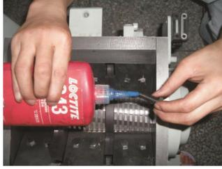
图 6-1: 维修保养刀具图
