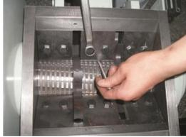
图 3-9: 定刀与动刀的安装示意图三
