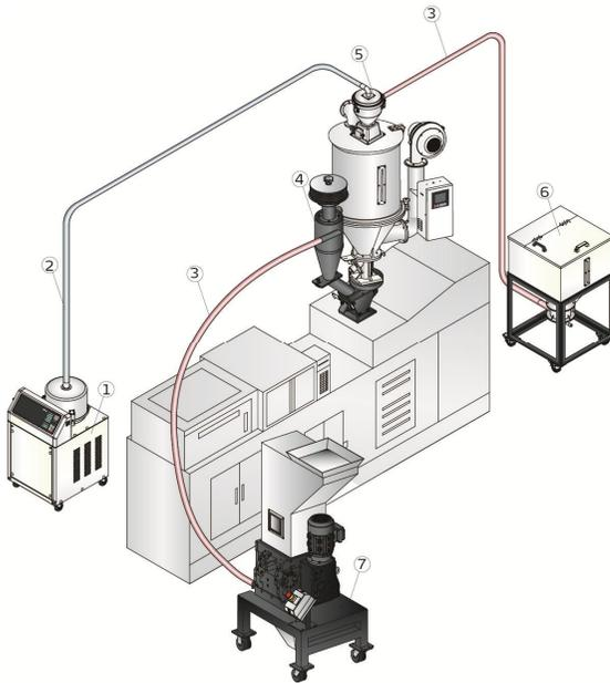
30 秒立即回收系统可轻易将集料盒内的粉碎料利用高压空气送回新次料比例调节器混合后再利用，使水口料不因氧化、湿化而产生生物性及颜色变化；提高水口料制成品的合格率。
