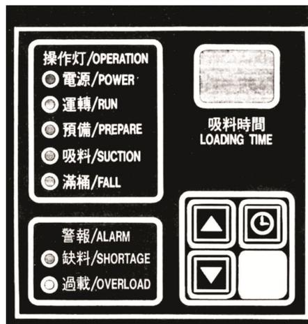
图 4-2：吸料参数设定图(SDS-500)
