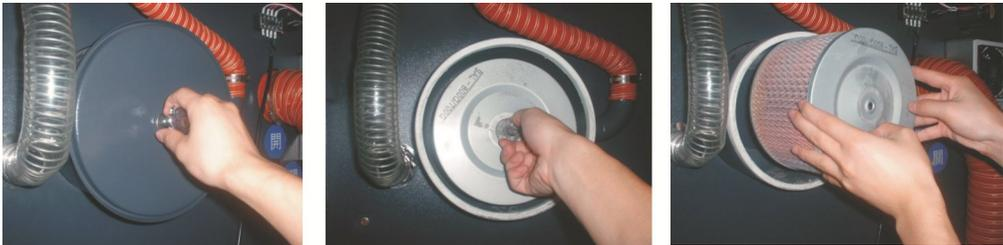
图 6-3：过滤器清洗步骤图
