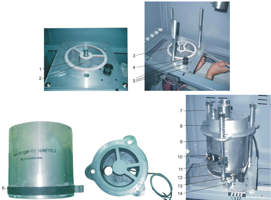
图 6-7: 蜂巢转轮安装示意图
