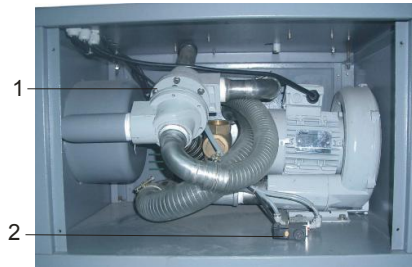
图 6-4: 吸料风机安装图
