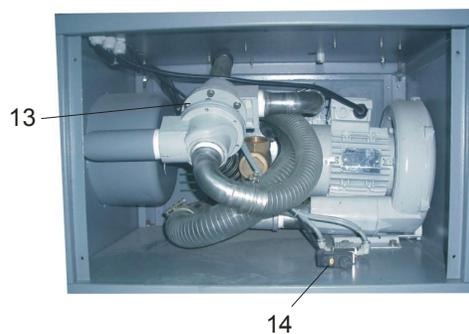
图 3-5: 吸料风机安装图
