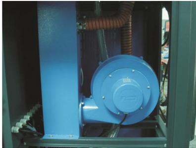
图 3-4: 干燥风机安装图
