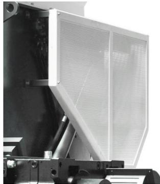
图 6-2：安装护罩
