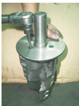
图 6-2: 档料板安装示意图
