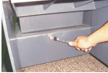
图 6-17: V形带的调整图一
