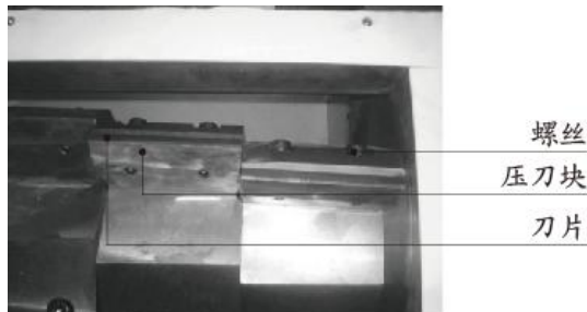
图 6-15: 动刀与定刀的安装
