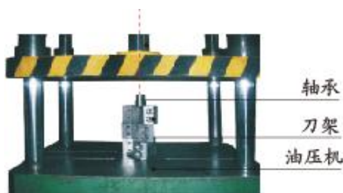
图 6-1: 刀架轴安装示意图
