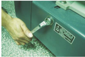
图 6-18: V形带的调整图二
