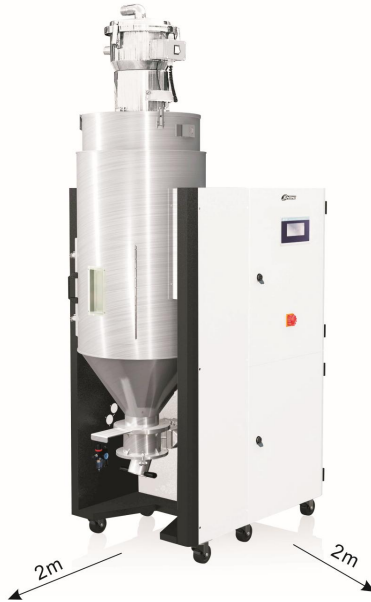
图 3-1: 机器安装要求图
