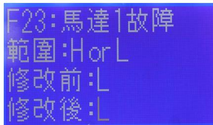
注：计量电机报警方式：L:电平报警， H: 高电平报警。
