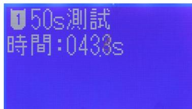
5) 按菜单键
