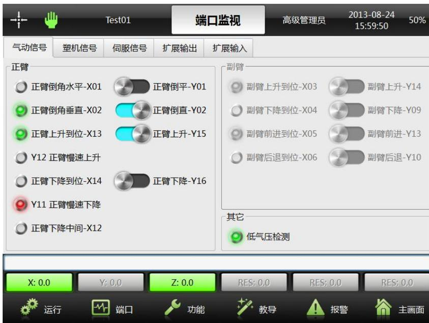
点击输出端口则控制对应输出端口开启和关闭：
