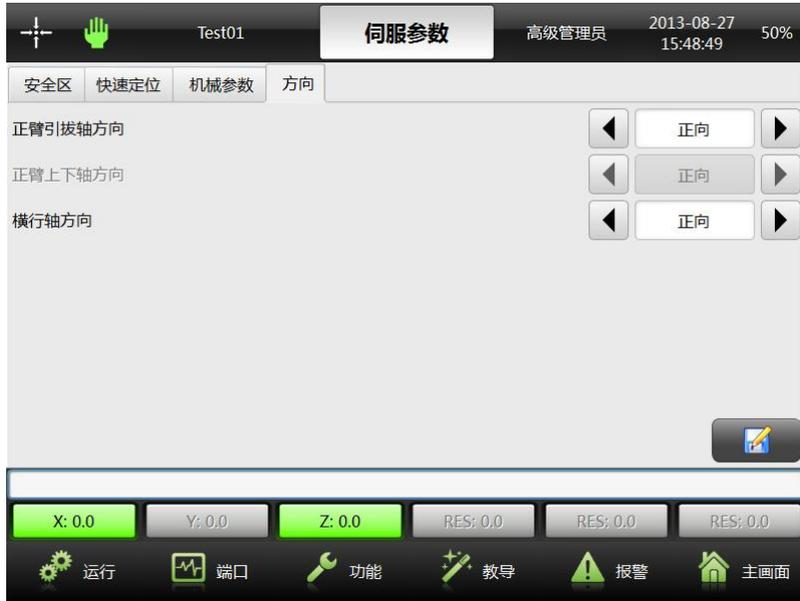
上图画面为主板配置为（横行伺服+引拔伺服）时的显示内容，正臂上下轴方向被隐含（灰色表示）。
