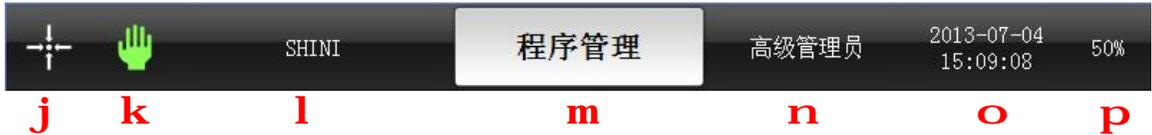
1) **伺服参考点标志:** 显示系统上电后伺服有无经过原点复归寻找参考点。点击该区块将会执行伺服原点复归操作。
