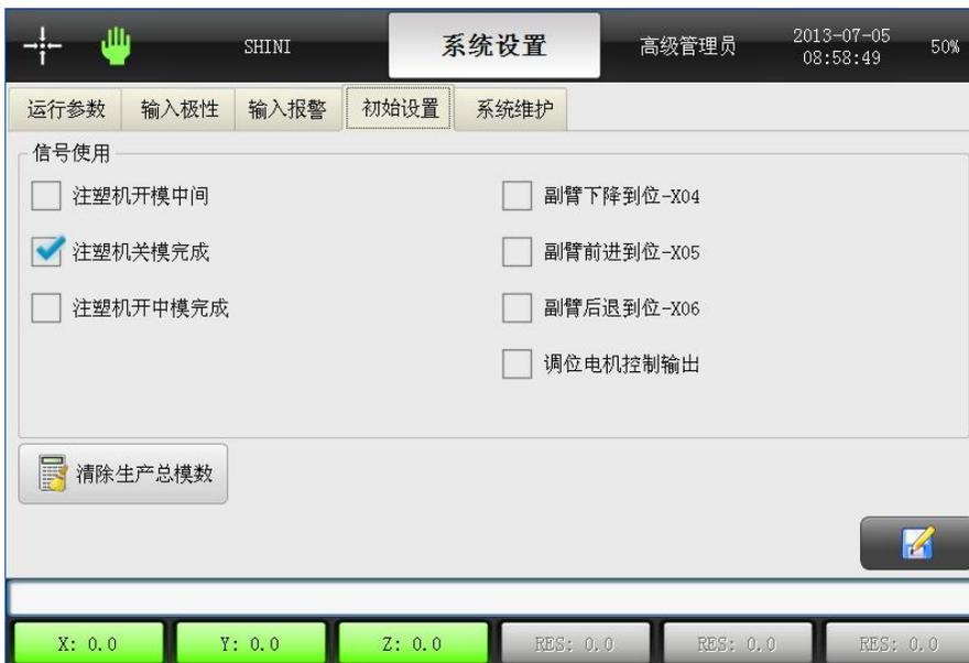
**信号使用：**设置部份信号是否使用，例如如果需要使用注塑机关模完成信号，那么请选中“注塑机关模完成信号”选项。
