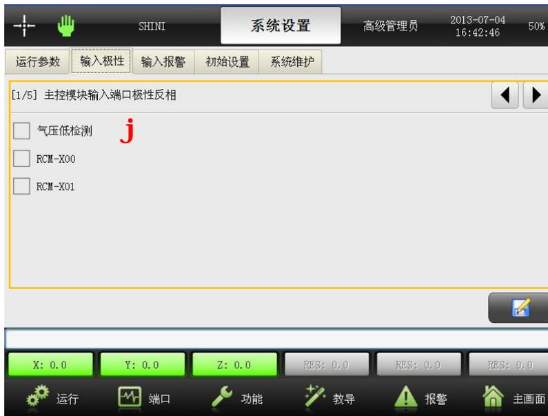
**输入极性**: 设置系统部份信号的有效极性, 例如如果需要低气压检测信号的有效极性是反相, 那么请选中“低气压检测反相”选项。
