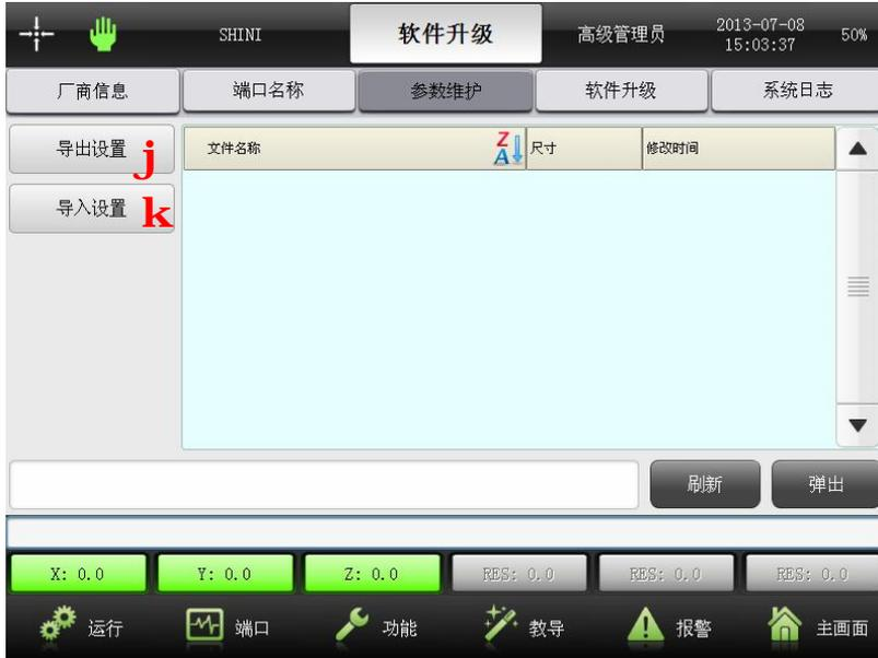
1) **导出设置**: 把系统参数和伺服参数设置数据导出到 USB 存储器中。
