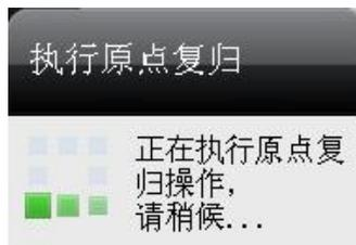
在伺服原点复归过程中，如果松开安全开关或者使劲完全按下安全开关，伺服原点复归操作将会马上中止。
