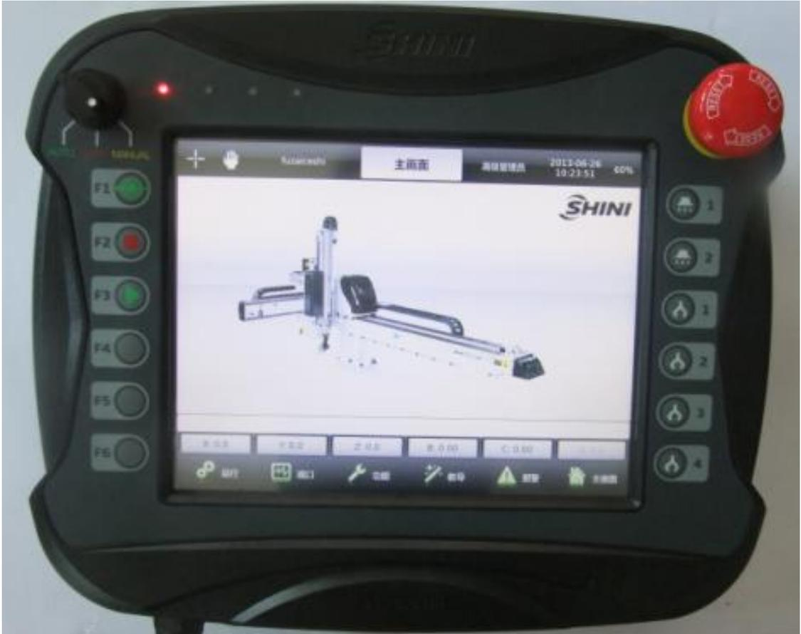
F1 机械手复归。(按下此按钮并同时按下手控器安全开关,机械手进入复归模式。)
