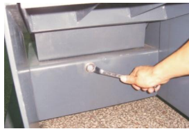
图 6-3: V 形带的调整图一
