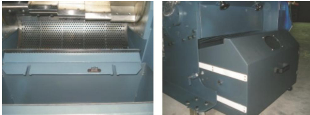
图 3-8: 筛网、网架及集料盒安装
