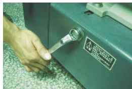
图 6-4: V 形带的调整图二
