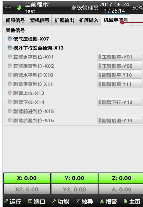
机械手信号：包含主臂倒角，气动副臂等端口监视及手动操作端口。其他气动信号，需在系统设置-初始设置里，开启相应的功能。
