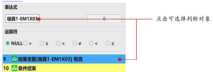
如需设置吸有效时，去做某件事。就可以在 9 和 10 步之间加入需要做的动作，这里只在吸到产品的情况才执行，没吸到产品就直接跳到条件结束的下一条指令执行。
