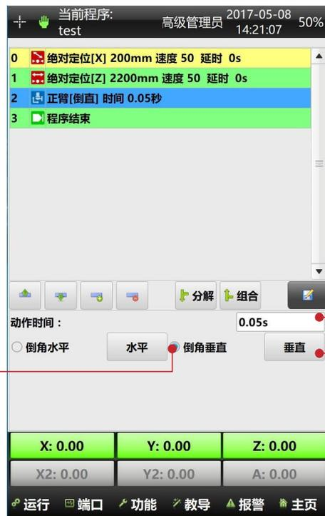
3、设定气动倒角动作时间。实际气动动作时间。时间到后，未检测到到位信号，则报警
