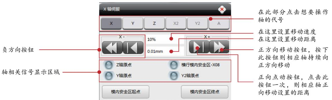
快速移动按钮，若在伺服设置里面设置了相关的位置，点击此按钮就可以快速移动到相应的位置
