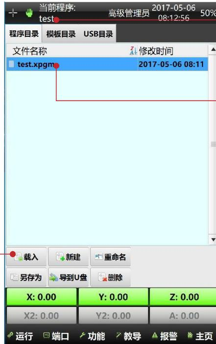
第三步，载入成功后，当前程序显示就会变成所选中的程序名，如果刚开始为没有载入程序，那么新建完成以后，直接更新为当前建的程序。
