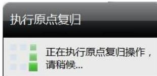
在各个画面，如果系统在手动模式，点击画面左上角的伺服参考点标志将执行伺服的原点复归操作：
