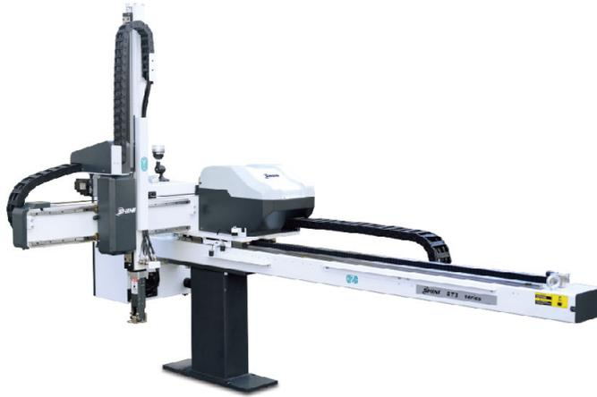
图 1-1：标准横走式三轴伺服机械手 ST3-900-1600T-S2
